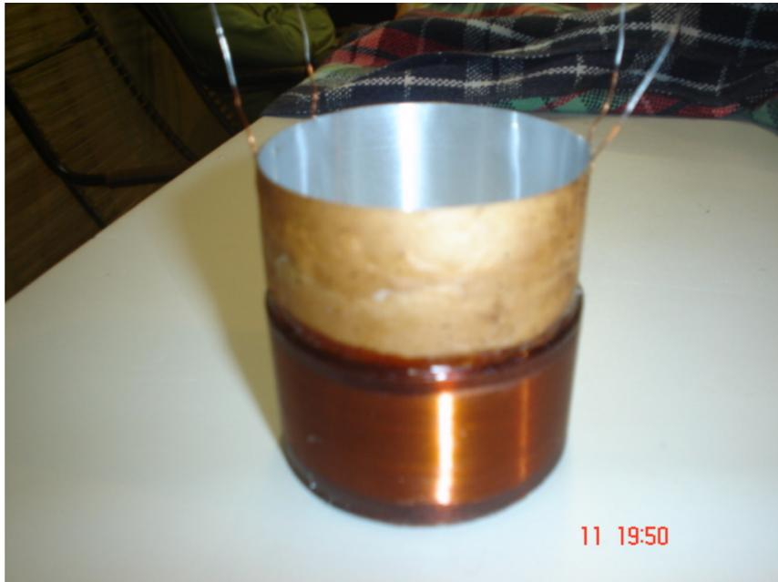
Figura 02 – Bobina com forma em alumínio para subwoofer de 12” diâmetro 64mm
