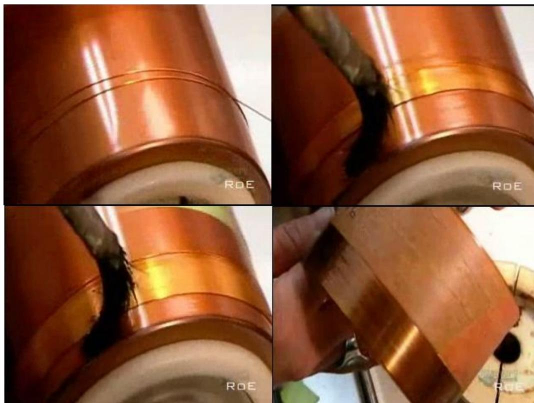
Figura 08 – Processo de enrolamento de uma bobina convencional.
