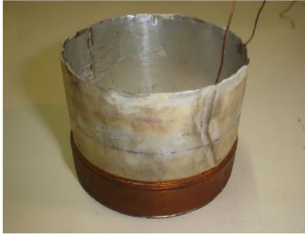
Figura: Modelo de Bobina Curta
